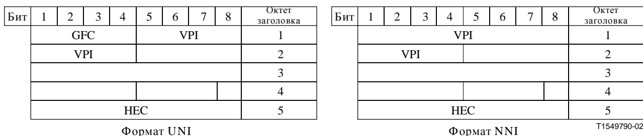
Рисунок 14-26/G.798 – Информация заголовка ячейки, обрабатываемая в ODUkP/VP_A_So
