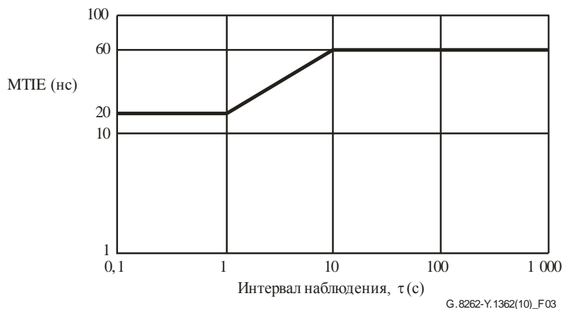
Рисунок 3 – Генерация фазового дрейфа (МТЕ) для ЕЕС-вариант 2 при постоянной температуре
