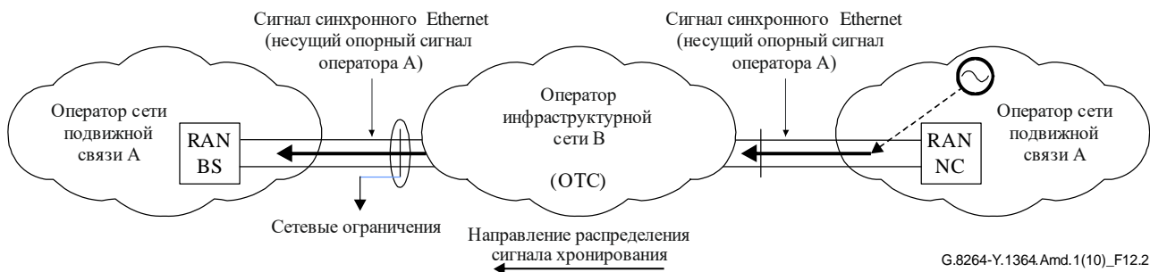
Рисунок 12-2 – Иллюстрация прозрачной в отношении хронирования передачи клиентских сигналов синхронного Ethernet в условиях наличия нескольких операторов
