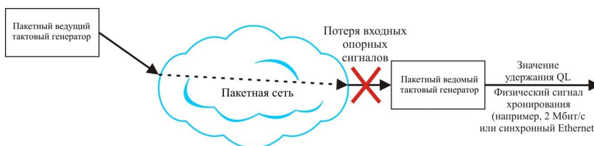
Рисунок 4 – Случай применения функции удержания QL на выходе пакетного подчиненного тактового генератора
