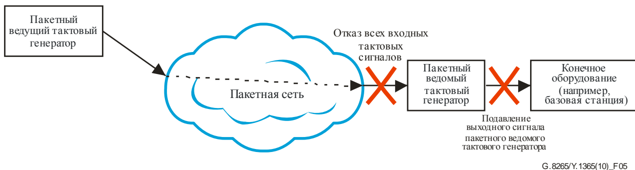
Рисунок 5 – Подавление на выходе пакетного подчиненного тактового генератора
