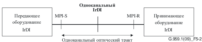
Рисунок 5-2 – Одноканальная эталонная конфигурация IrDI
