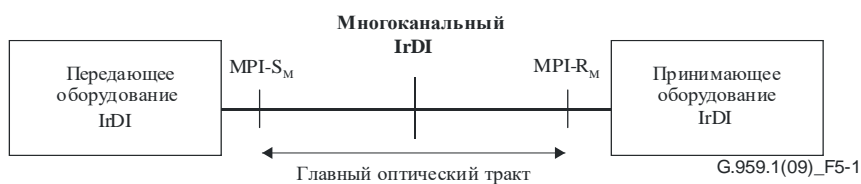
Рисунок 5-1 – Многоканальная эталонная конфигурация IrDI
