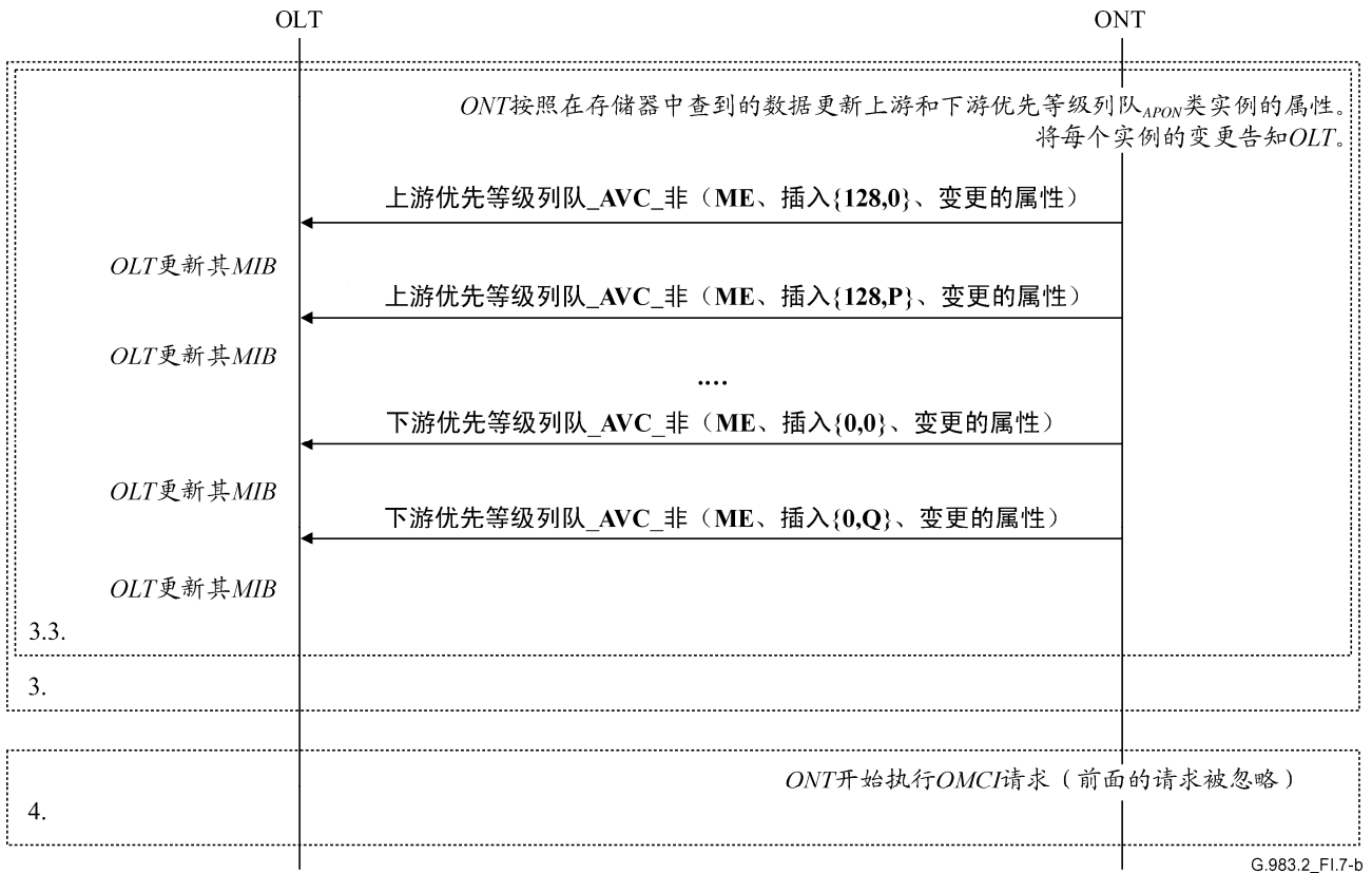
图 I.7b/G.983.2—两侧有集成化接口的“新” ONT的启动步骤
