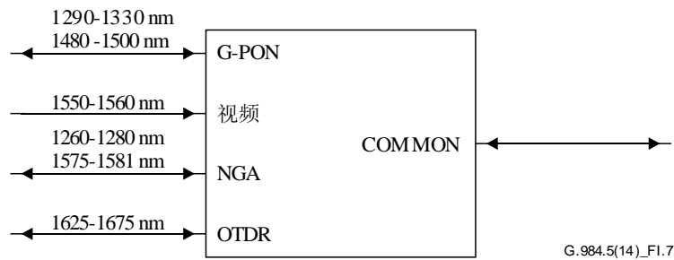
图I.7 – 支持G-PON、RF视频、NGA和OTDR的WDM1r参考图
