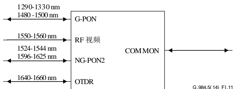
图I.11 – 支持G-PON、RF视频、NG-PON2和OTDR的CE x 参考图
