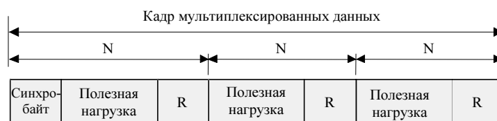
Рисунок I.16/G.992.1 – Структура кадра мультиплексированных данных для факультативного режима формирования кадров данных S = 1/3
