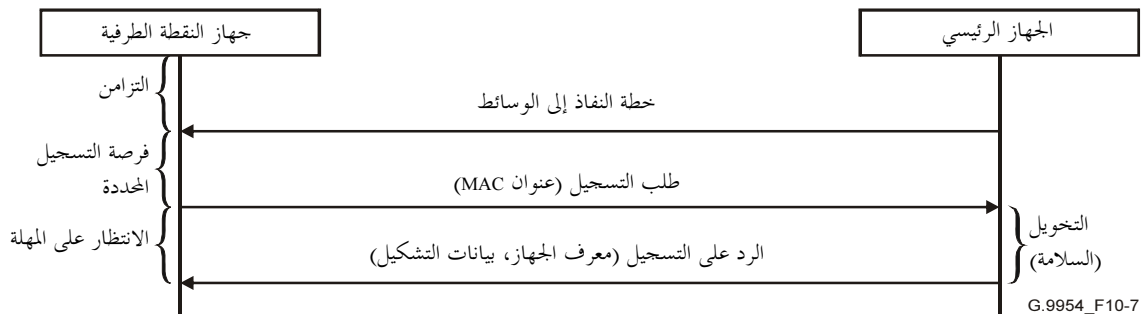
الشكل 7-10/G.9954 - مخطط تتابع بروتوكول انضمام الشبكة
