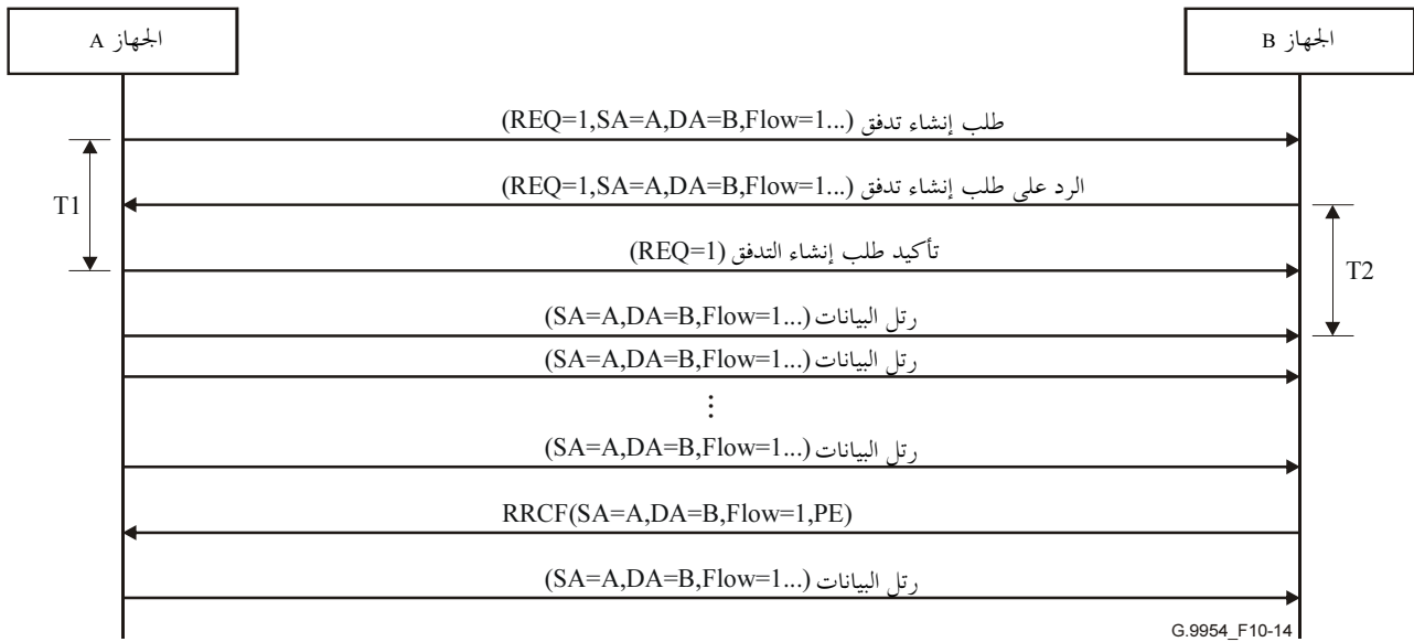
الشكل 10-14 G.9954 - إجراء إنشاء التدفق بمبادرة المصدر
