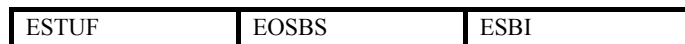
Figura C.1/H.263 – Diagrama de sintaxis para indicadores de final de subtren de bits
