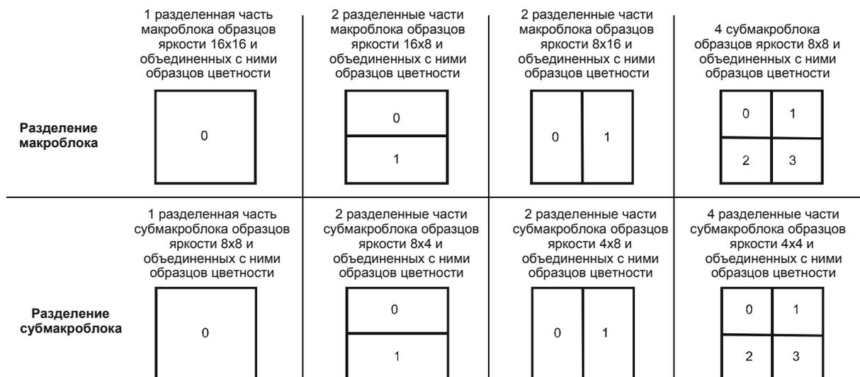
**Рисунок 6-9 – Разделенные части макроблоков и субмакроблоков. Сканированные разделенные части макроблоков и субмакроблоков**
