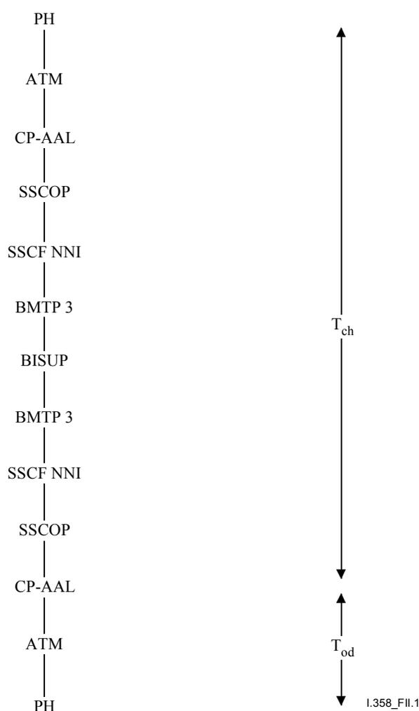
**Figura II.1/I.358 – Modelo de referencia para el tiempo de tratamiento  $T_{ch}$  a través de la central**
