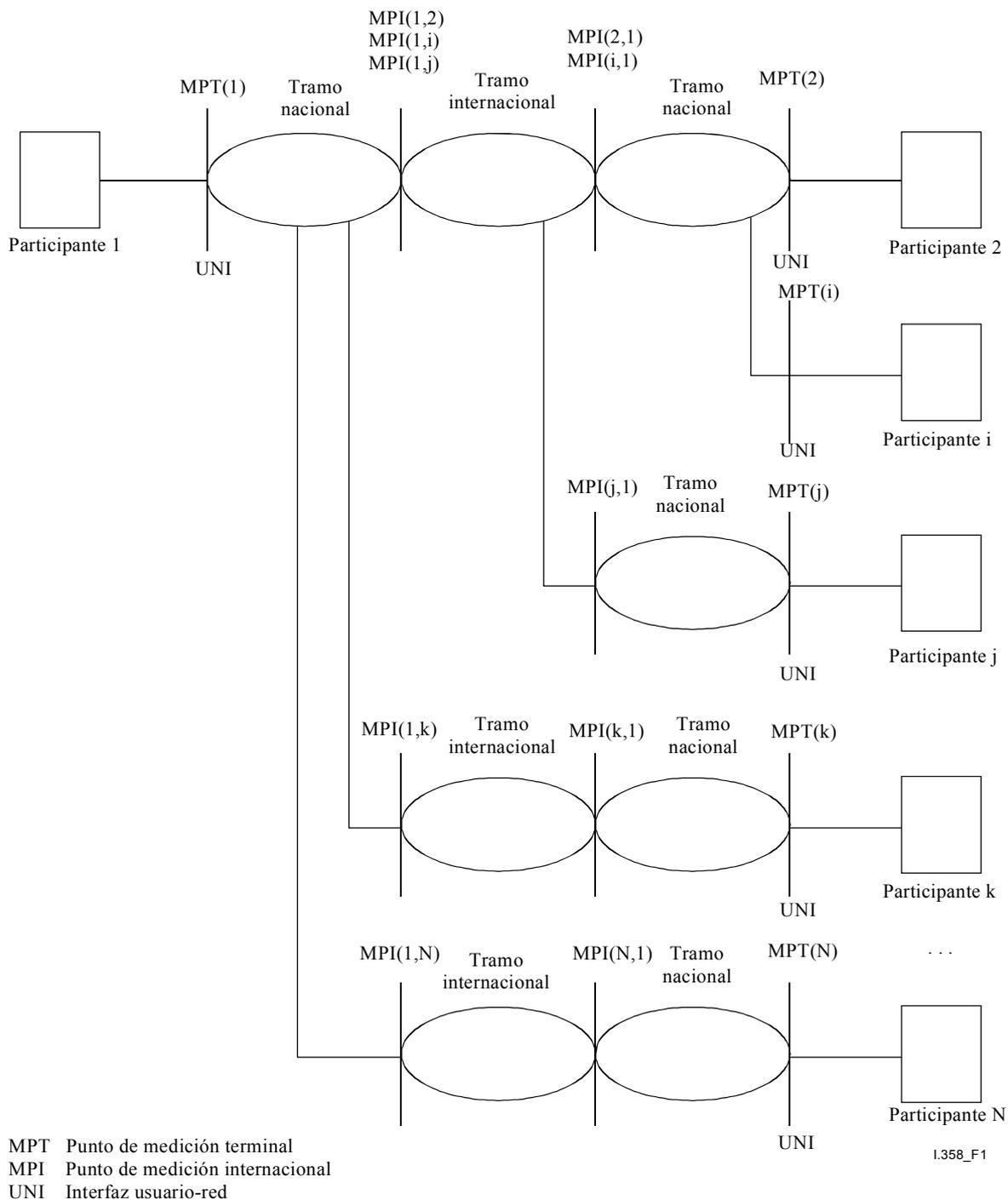
**Figura 1/I.358 – Configuración de referencia de calidad del procesamiento de llamada en la RDSI-BA**
