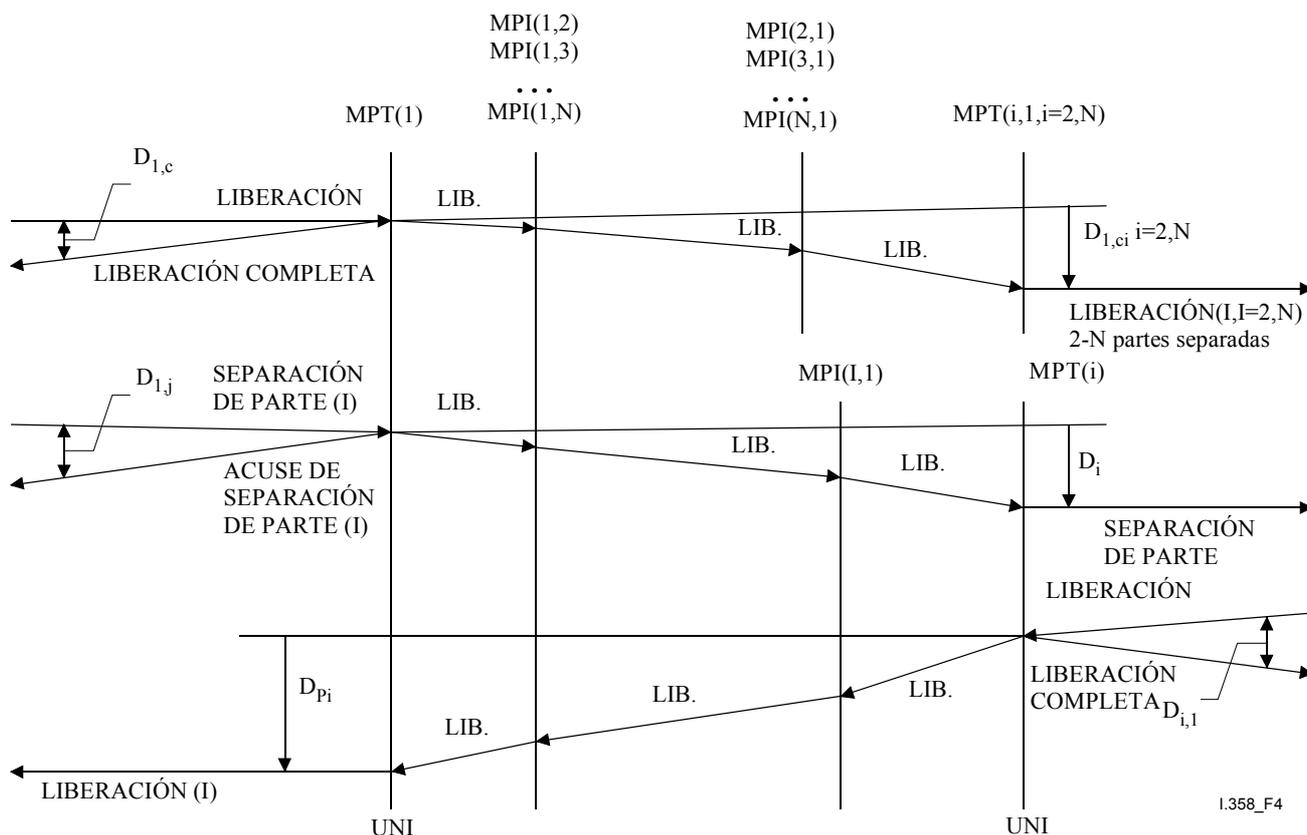
**Figura 4/I.358 – Retardos del procesamiento de desconexión de la llamada para una llamada en la RDSI-BA tipo 2**
