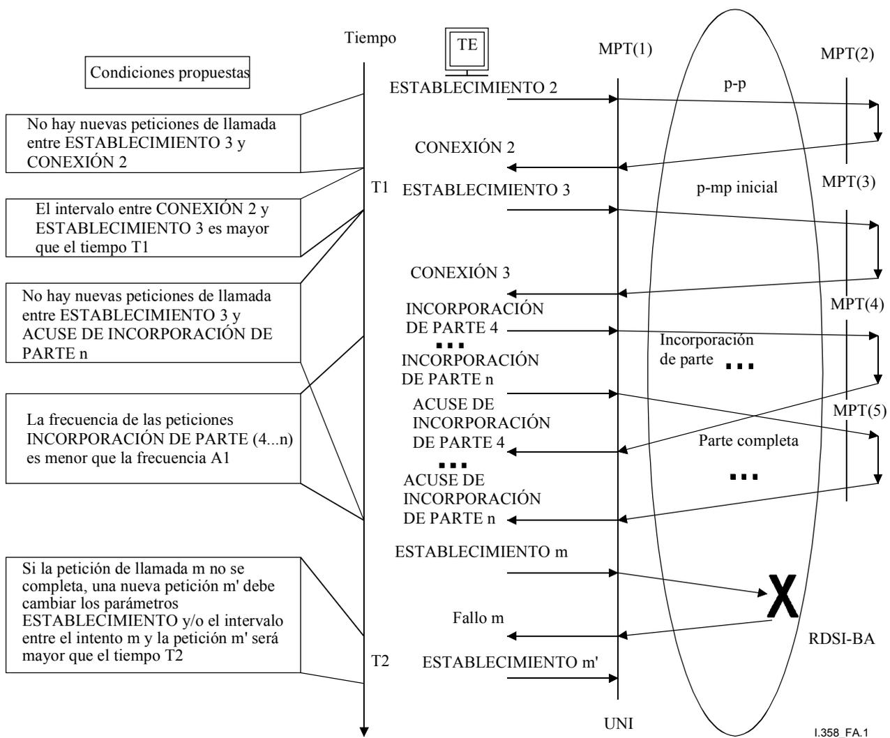
**Figura A.1/I.358 – Condiciones para intentos de llamada en la UNI**
