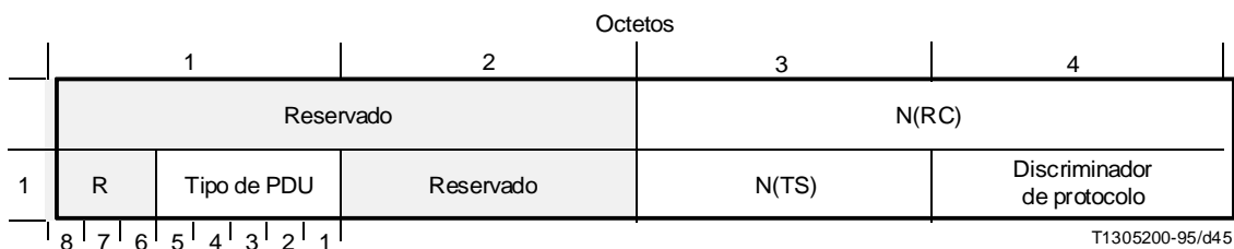
FIGURA D.2/I.365.2 Acuse de recibo de confirmación de recepción (PDU RCAF)
