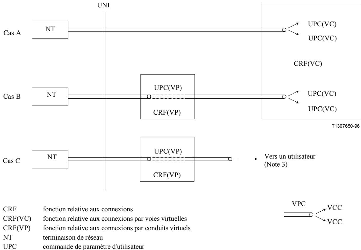
NOTE 1 – Dans les cas B et C, la valeur de l'identificateur VPI identifie obligatoirement une connexion VPC.
