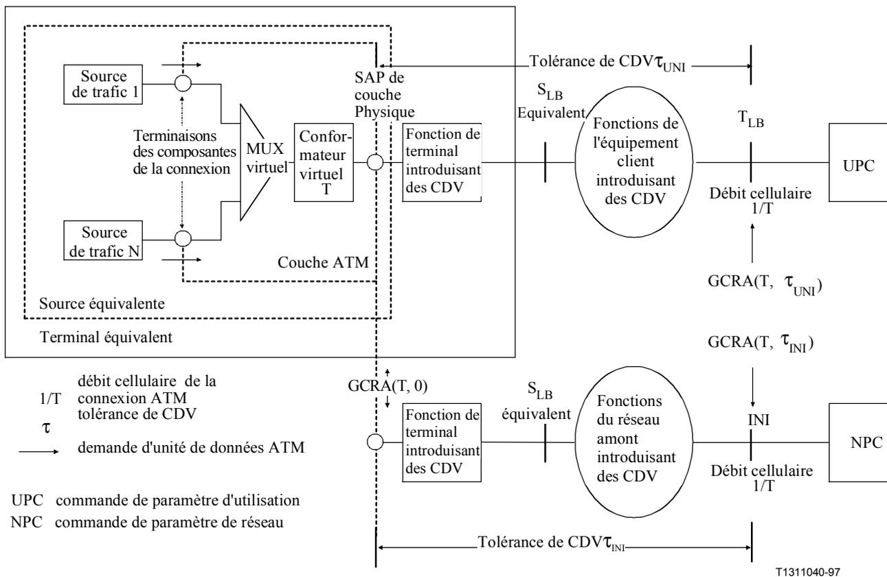
**Figure 5/L.371 – Source équivalente et terminal équivalent pour la définition d'un débit cellulaire d'une connexion ATM**
