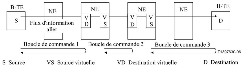
**Figure 15/I.371 – Exemple d'une connexion virtuelle segmentée**
