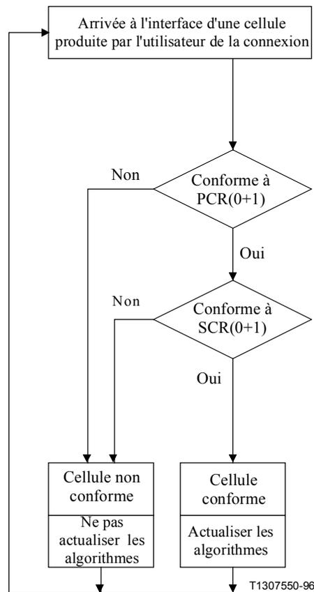
**Figure 7/I.371 – Définition de conformité pour la configuration SBR1**
