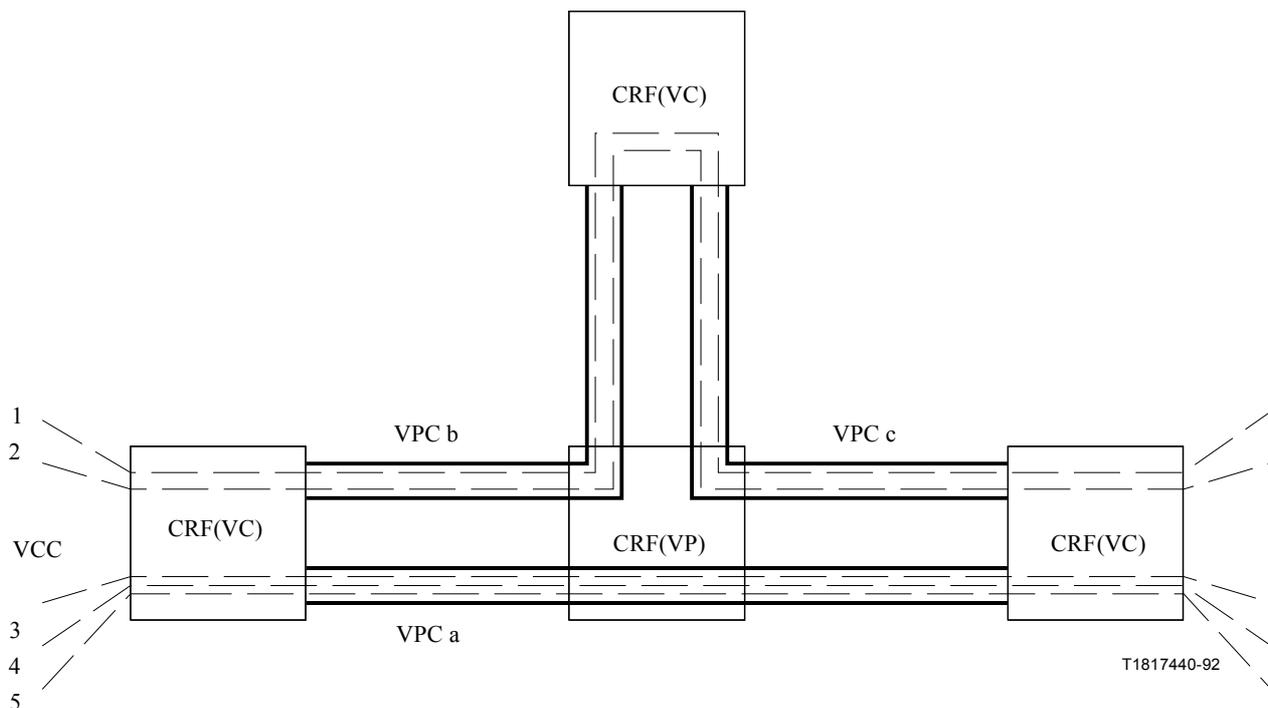
CRF (VC), CRF (VP) fonction relative aux connexions par voies virtuelles (VC) ou par conduits virtuels (VP)
