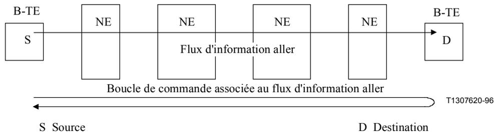
**Figure 14/I.371 – Exemple d'une boucle de régulation de débit ABR entre une source et sa destination**
