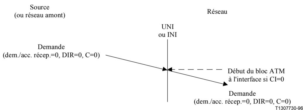
**Figure C.1/I.371 – Réduction du débit BCR déclenchée par la source**
