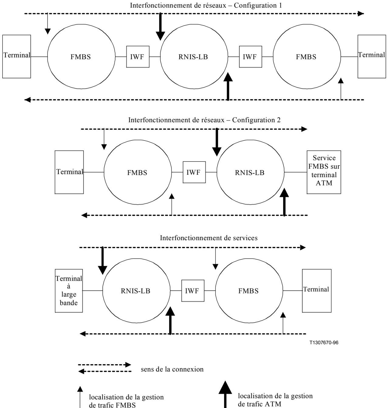
**Figure 20/L.371 – Configurations de référence dans le cas d'un interfonctionnement FMBS-RNIS à large bande**
