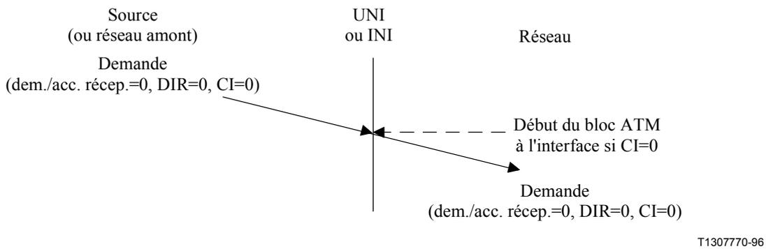
**Figure D.1/I.371 – Modification du débit BCR déclenchée par la source**
