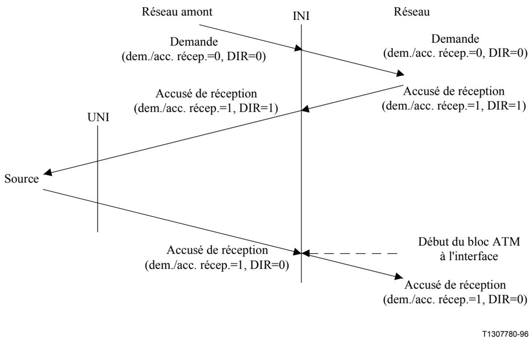
**Figure D.2/I.371 – Modification du débit BCR déclenchée par le réseau dans le sens direct**
