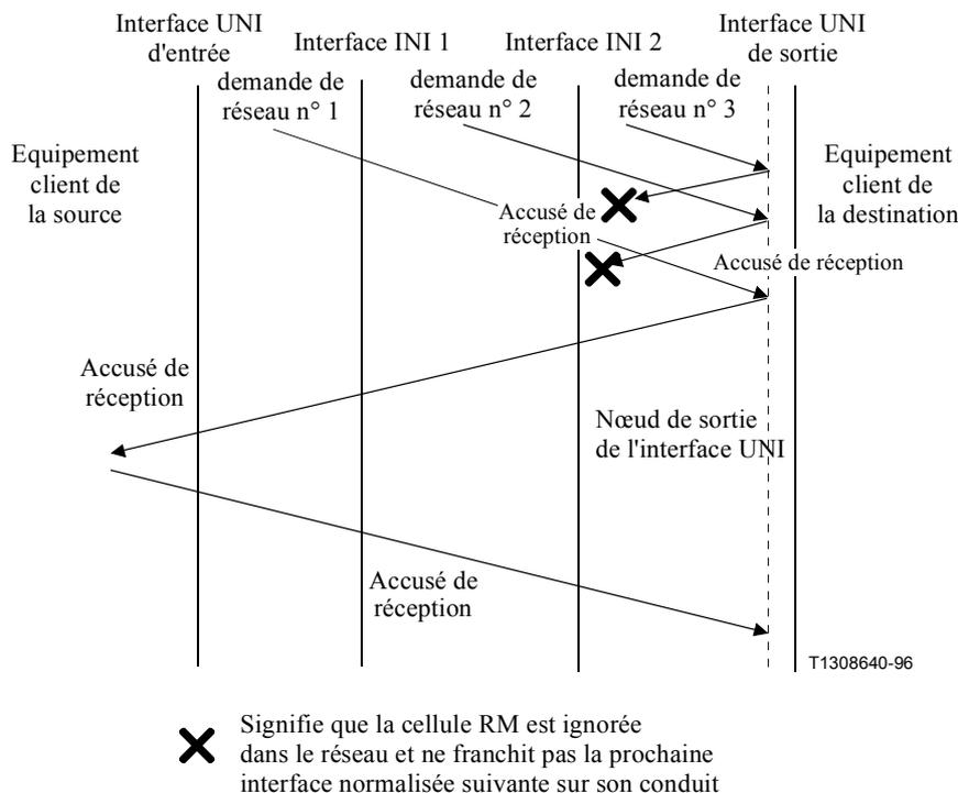
**Figure E.1/I.371 – Refus de négociation du débit BCR dans le réseau de départ, ou un réseau en aval (les cellules RM ont différents numéros de séquence)**
