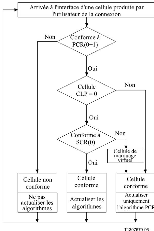
NOTE – Le terme "marquage virtuel" est utilisé parce qu'une définition n'étant pas un dispositif physique n'est pas en mesure de modifier un bit dans une cellule ATM. Toutefois une commande UPC/NPC qui implémente l'option de marquage fera effectivement passer le bit CLP de 0 en 1.
