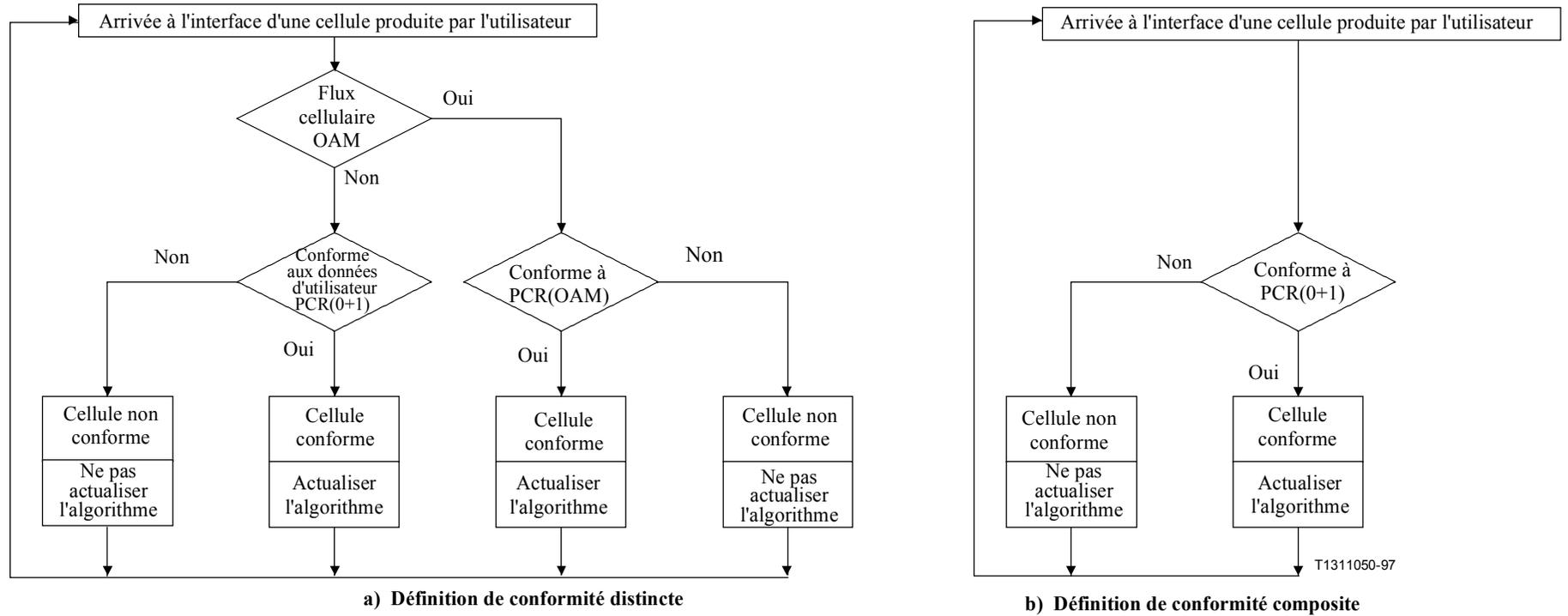
**Figure 6/I.371 – Définition de conformité applicable au débit DBR**
