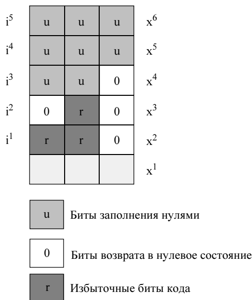
Рисунок 6-11/J.122 – Пример битов возврата в ноль, за которыми следуют "нули"
