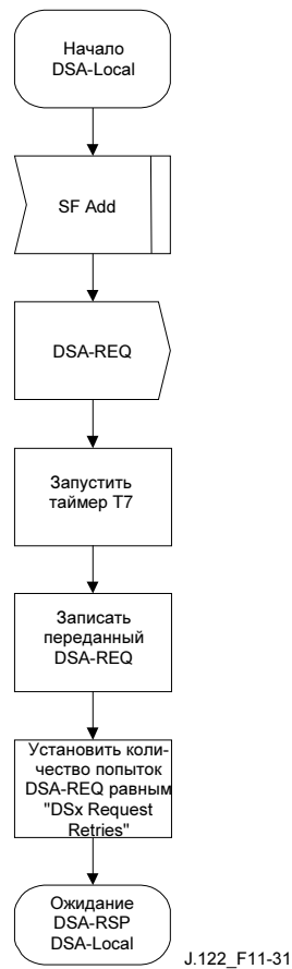
Рисунок 11-31/J.122 – DSA – Диаграмма перехода состояний локально инициированной транзакции начала
