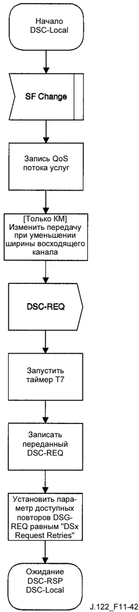
Рисунок 11-42/J.122 – DSC – Диаграмма перехода состояний локально инициированной транзакции ожидания DSC-RSP
