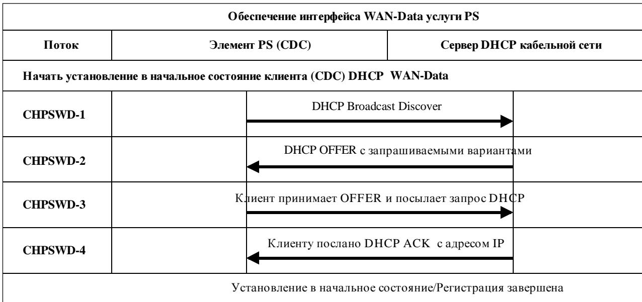
Рисунок 42/J.191 – Процесс обеспечения WAN-data услуги PS
