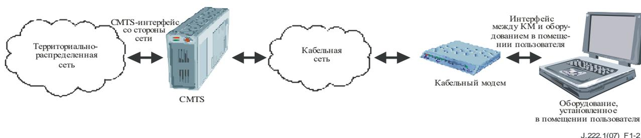
**Рисунок 1-2 – Прозрачная передача IP-трафика через систему передачи данных по кабелю**
