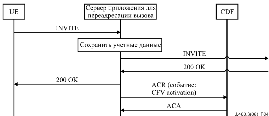
Рисунок 4 – Активация переадресации вызова с использованием адреса, предоставленного пользователем
