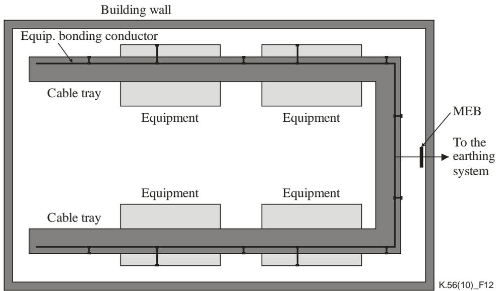
**Figure 12 – Equipotential bonding conductor in the cable trays**
