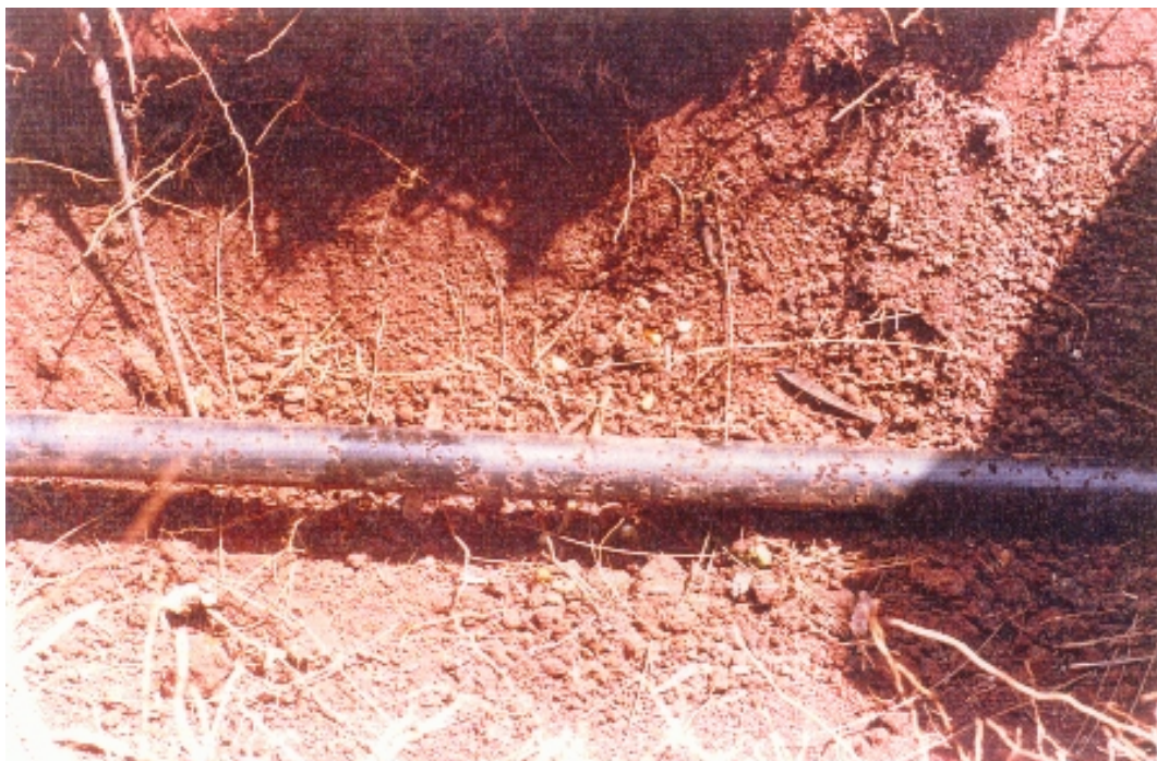
Figure II.7/L.46 – Câble métallique endommagé par des insectes
