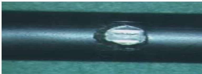
Figure II.3/L.46 – Exemple de dommage causé par des chenilles
