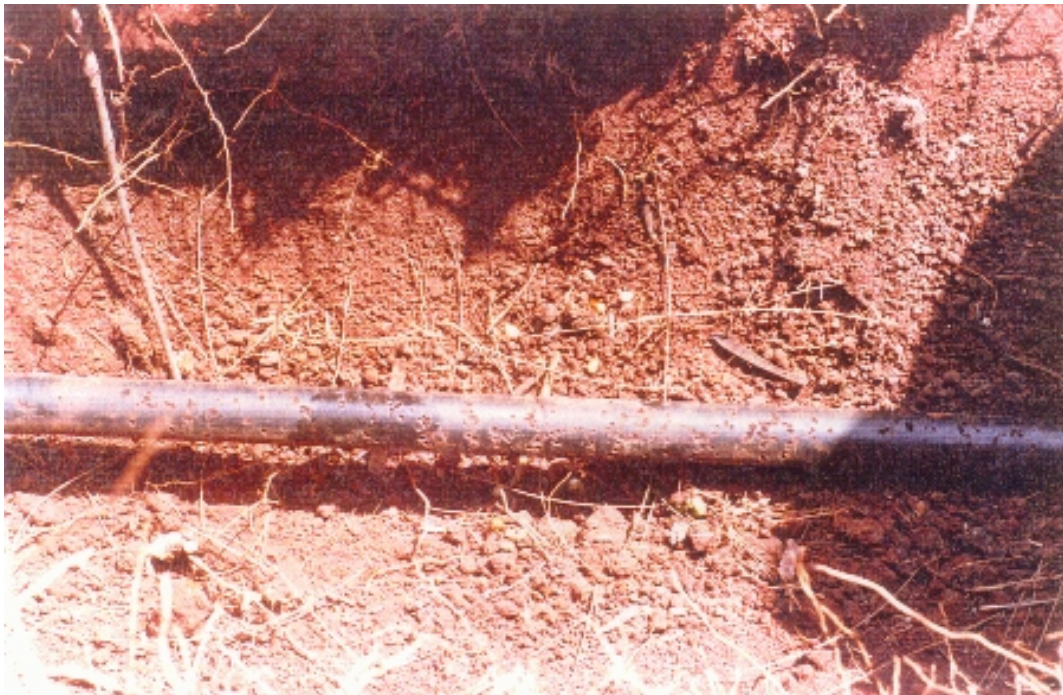
Figura II.7/L.46 – Cable metálico dañado por los insectos
