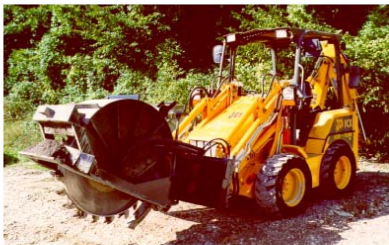
Figure 2/L.48 – Exemple d'engin type de tranchage
