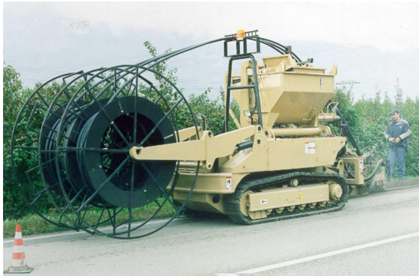
Figure 3/L.48 – Exemple de machine de tranchage entièrement automatisée
