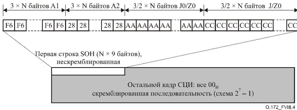
**Рисунок VIII.4/O.172 – Тестовая последовательность 1**
