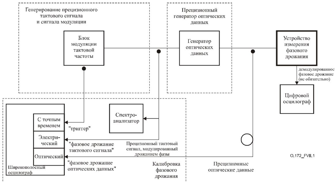
Рисунок VII.1/О.172 – Блок диаграмма системы проверки
