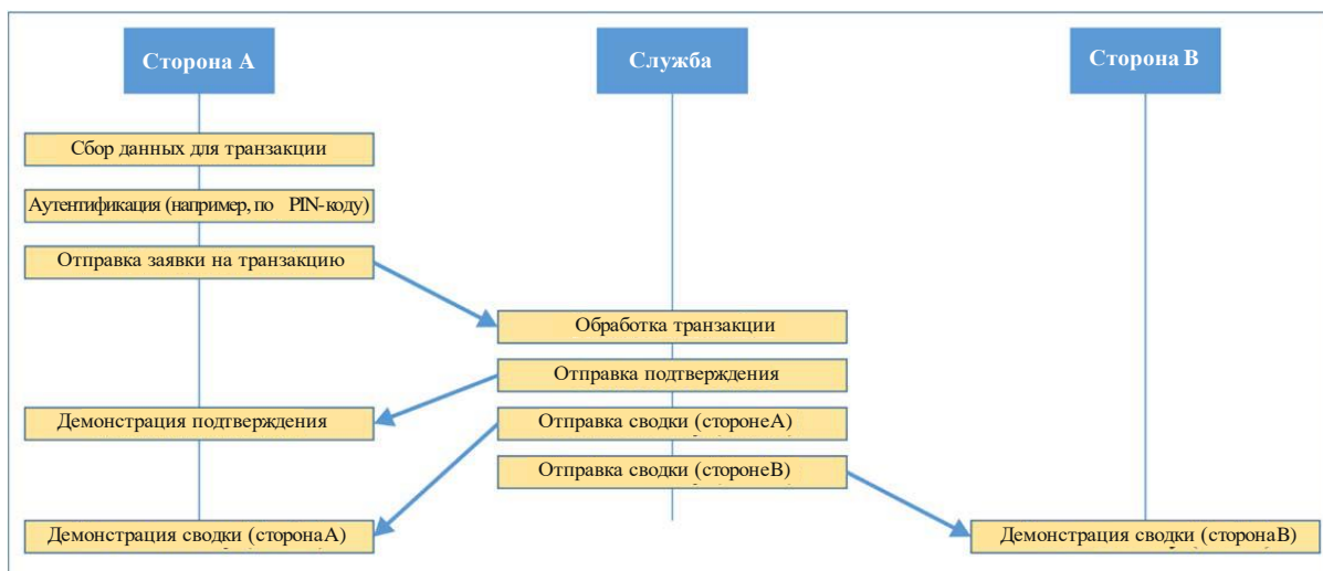
Рисунок 1 – Участники и последовательность событий при реализации DFS, когда необходимая информация собирается локально, а затем передается в службу (вариант А)
