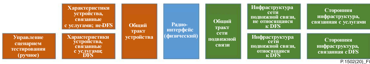
Рисунок 4 – Общая модель элементов, участвующих во взаимодействии между стороной А и системой DFS
