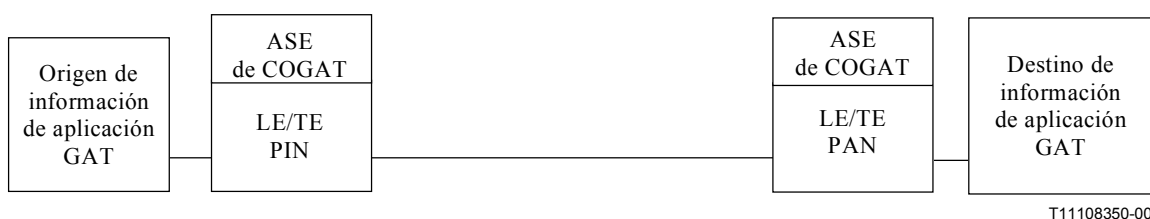
Figura 2/Q.765.4 – Ejemplo de una comunicación no relacionada con portador entre dos nodos para una aplicación GAT y su relación con el concepto de nodos PIN/PAN de la NNI pública
