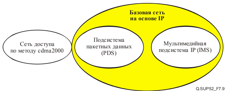
Рисунок 7.9 – Упрощенная архитектура разработанной в рамках стандарта ANSI-41 и полностью основанной на IP базовой сети с сетью доступа по методу cdma2000
