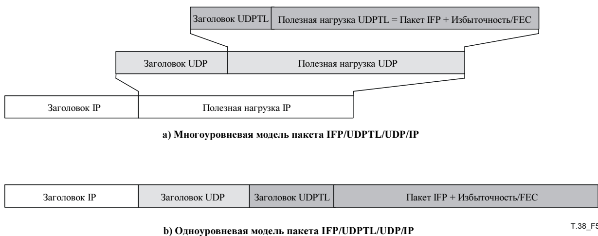
Рисунок 5/Т.38 – Структура пакета UDPTL/UDP/IP высокого уровня
