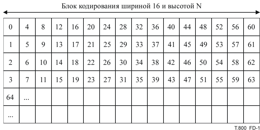
Рисунок D.1 – Пример шаблона сканирования битовой матрицы блока кодирования
