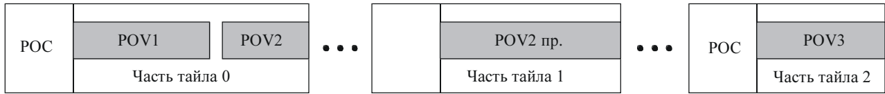
а) Все значения порядка последовательности описаны в сегментах маркера РОС в заголовке первой части тайла
