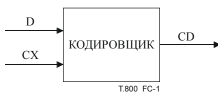
Рисунок С.1 – Входы и выходы арифметического кодировщика
