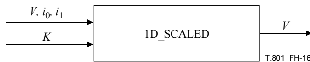
Figura H.16 – Parámetros del procedimiento 1D_SCALED
