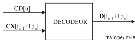
**Figure H.5/T.810 – Décodeur arithmétique JPEG 2000 – partie 1 actionné par le rythme binaire**
