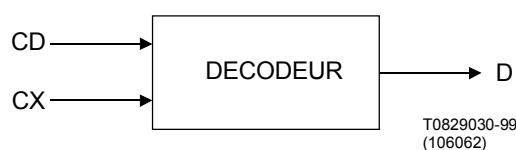
Figure E.13 – Entrées et sorties du décodeur arithmétique
