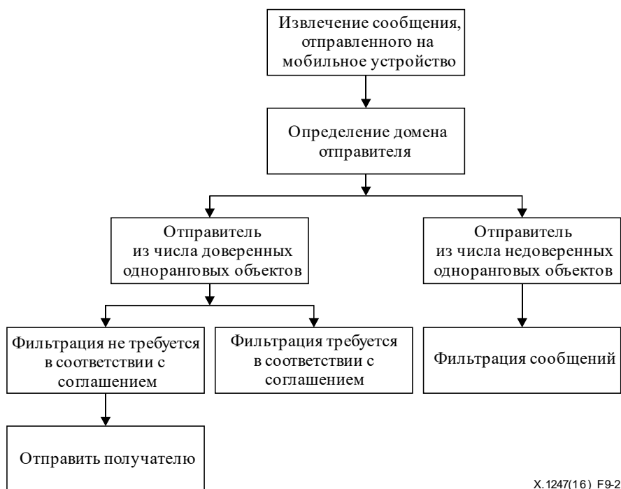
Рисунок 9-2 – Поток обработки сообщений, отправленных на мобильные устройства, в APg
