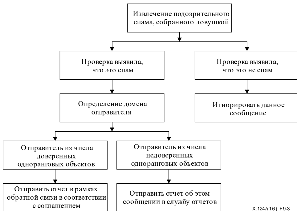
Рисунок 9-3 – Поток обработки сообщений, отправленных на мобильные устройства, в АМон
