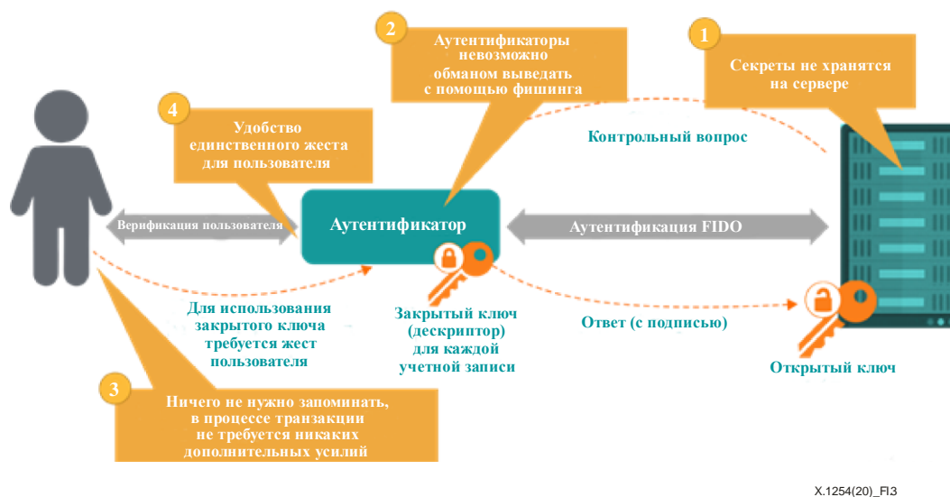
Рисунок I.3 – Новая система аутентификации на основе Рекомендации [b-ITU-T X.1278]
