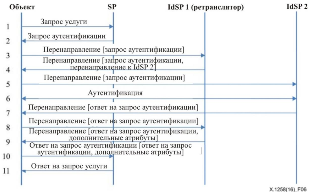
Рисунок 6 – Последовательность объединения атрибутов с использованием метода ретрансляции идентичности
