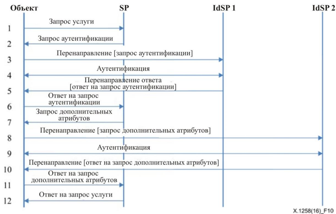
Рисунок 10 – Последовательность объединения атрибутов с использованием метода поставщика услуг
