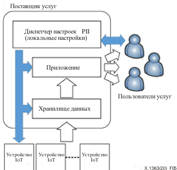
Рисунок 5 – Техническая структура обработки данных РП одним поставщиком услуг
