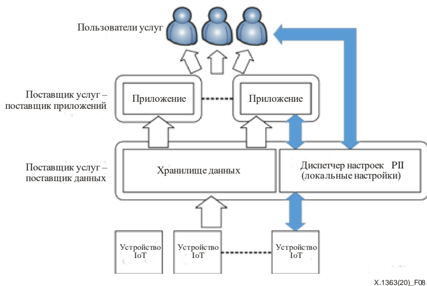
Рисунок 8 – Техническая структура обработки данных РП в услугах IoT несколькими поставщиками услуг
