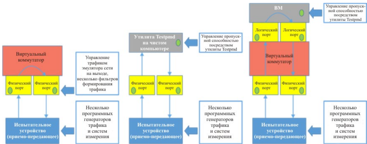
Рисунок X.1 – Три возможных способа тестирования на вычислительной платформе общего назначения
