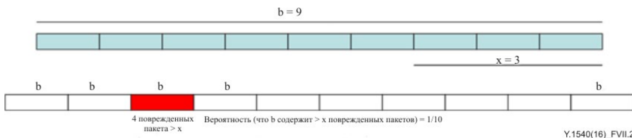
Рисунок VII.2 – Иллюстрация расчета параметров рабочих характеристик для восстановления потока
