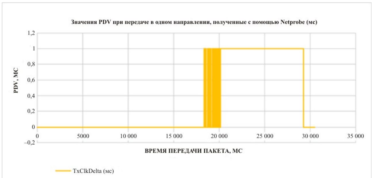
Рисунок X.7 – Измерение с помощью NetProbe вариации задержки пакетов в течение 11 с; UDP, 971 Мбит/с
