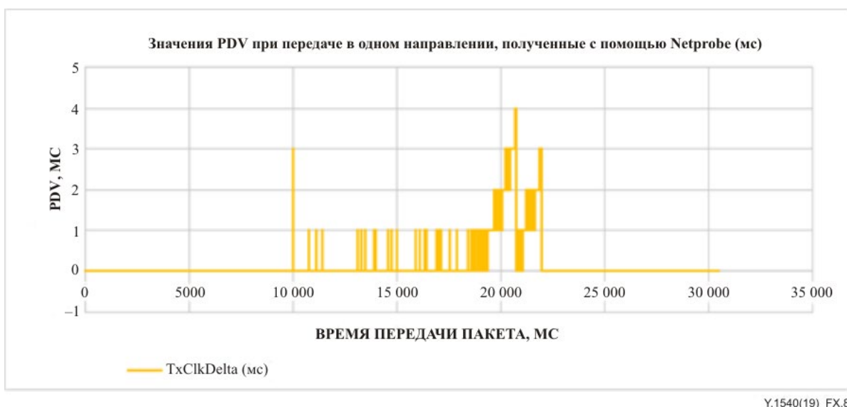
Рисунок X.8 – Измерение PDV с помощью NetProbe в течение 12 с при трех TCP-соединениях
