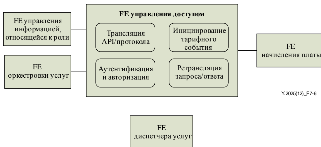
Рисунок 7-6 – Функциональное представление FE управления доступом
