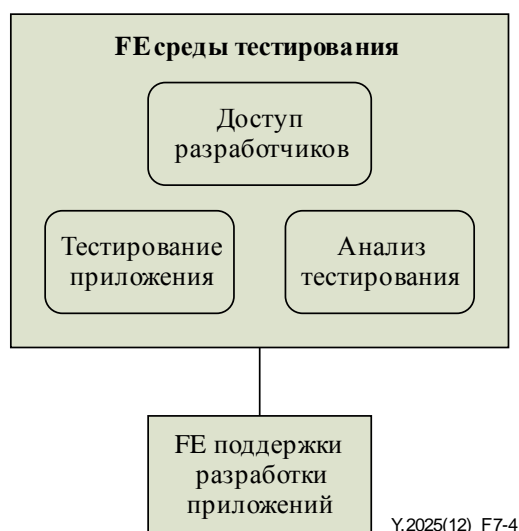
Рисунок 7-4 – Функциональное представление FE среды тестирования
