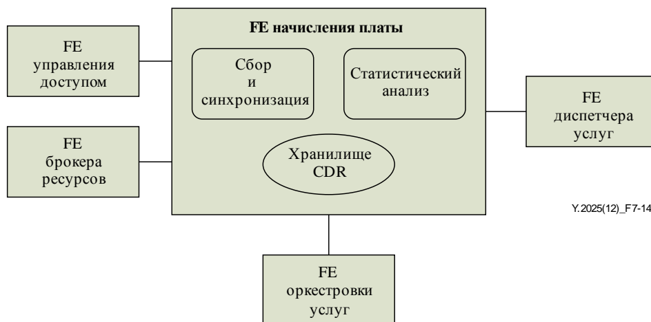
Рисунок 7-14 – Функциональное представление FE начисления платы
