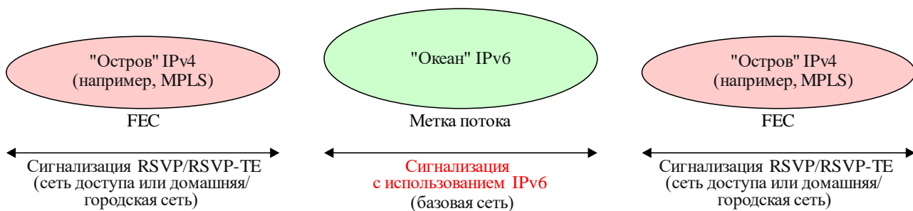
Рисунок 5 – Преобразование сигнализации между IPv6 и IPv4 (этап 2)
