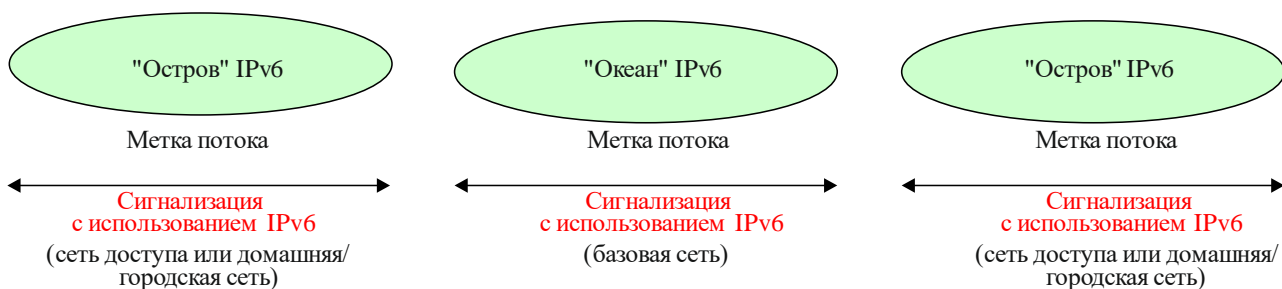
Рисунок 6 – Преобразование сигнализации между IPv6 и IPv4 (этап 3)
