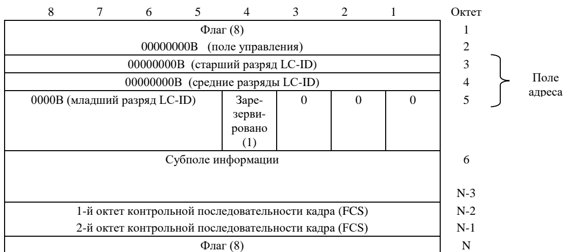
Рисунок 6-5 – Структура кадра управления в режиме, ориентированном на соединение
