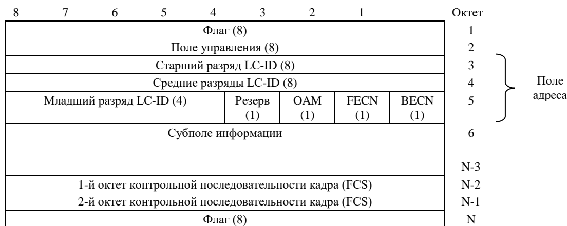
Рисунок 6-4 – Структура кадра данных в режиме, ориентированном на соединение
