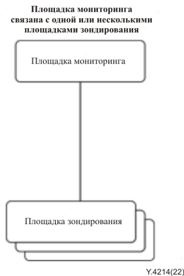
Рисунок 3 – Взаимосвязь агрегирования между площадкой мониторинга и площадкой зондирования
