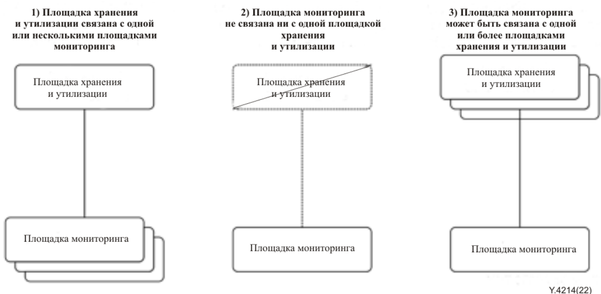
Рисунок 4 – Взаимосвязь агрегирования между площадкой хранения и утилизации и площадками мониторинга
