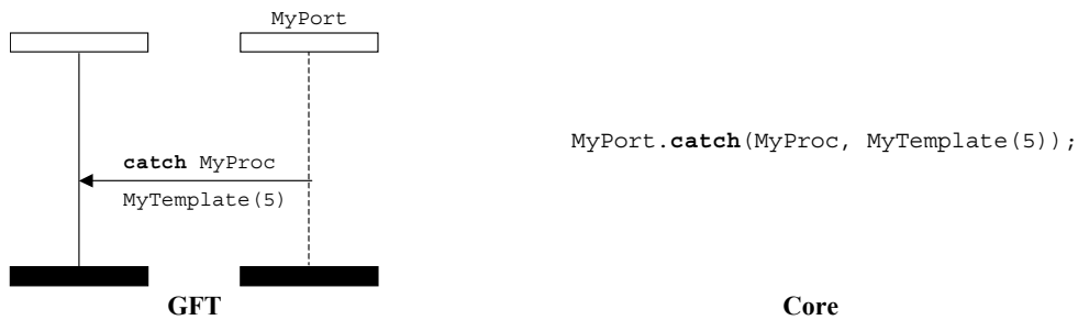
Figure 86/Z.142 – Opération d'acquisition avec référence de modèle (hors d'un symbole d'appel)
