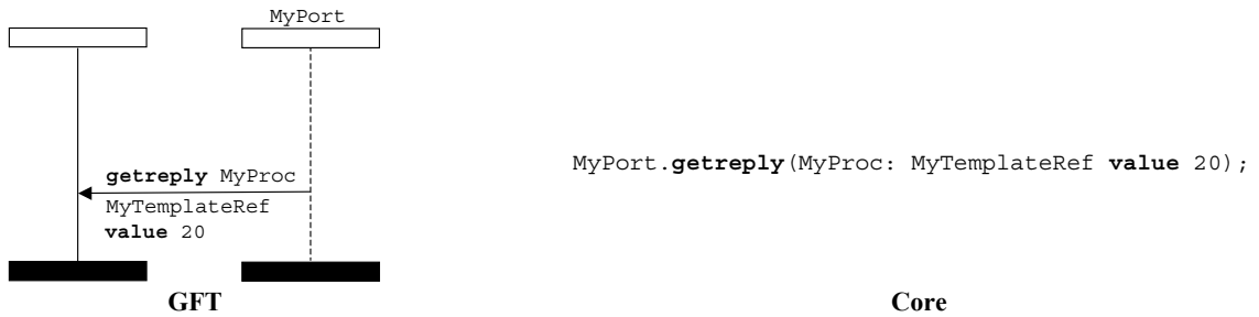
Figure 76/Z.142 – Opération d'obtention de réponse avec référence de modèle (hors d'un symbole d'appel)
