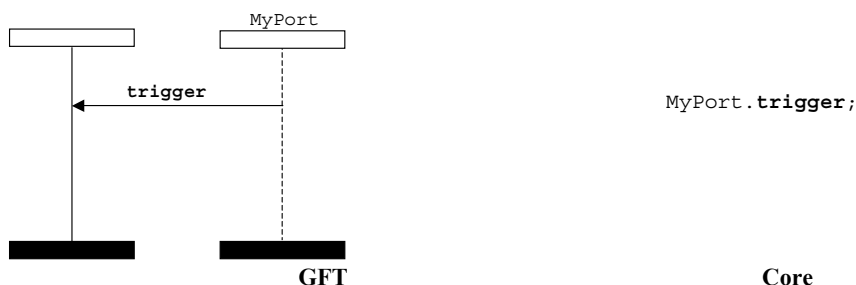
Figure 60/Z.142 – Opération déclenchement à tout message
