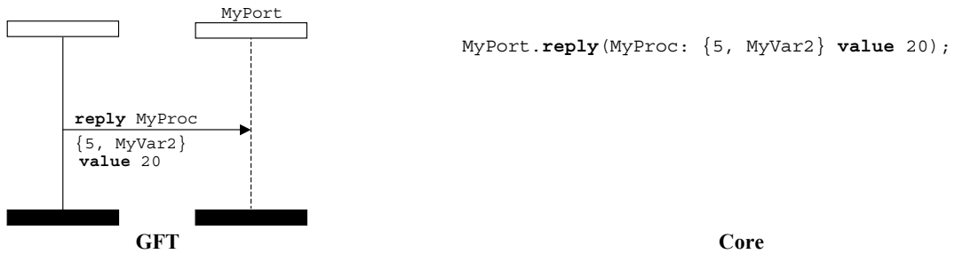
Figure 73/Z.142 – Opération de réponse avec modèle en ligne
