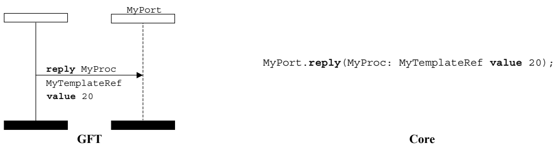
Figure 72/Z.142 – Opération de réponse avec modèle de référence
