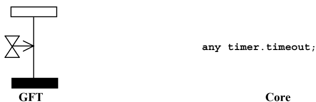
Figure 109/Z.142 – Opération de fin de temporisation à partir d'un temporisateur quelconque
