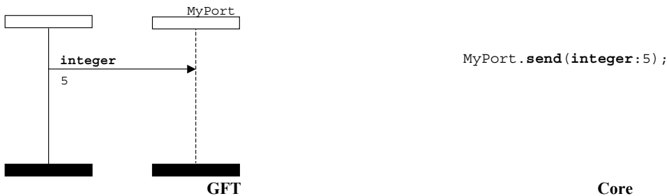
Figure 53/Z.142 – Opération d'envoi avec modèle en ligne
