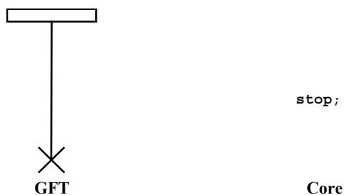
Figure 45/Z.142 – Opération d'arrêt d'exécution
