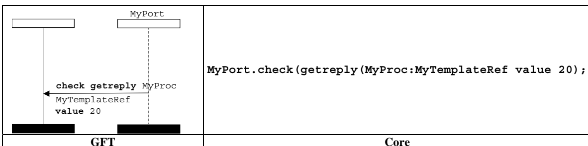
Figure 95/Z.142 – Vérification d'une opération d'obtention de réponse (hors d'un symbole d'appel)
